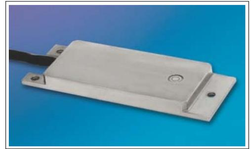
LLE-5DC-500系列传感器是一款用于风洞试验，飞行测试，喷嘴压力测试和机身压力测量的性能卓越的压力传感器。该产品重量轻，紧凑的扁平封装结构使其非常适合直接粘贴在测试部件表面测量压力。该产品采用了KULITE无引线专利技术并融合了其它先进制造技术。该传感器系列带有数字修正式放大器，可以使其总误差在温度补偿范围内达到0.25% FS。
